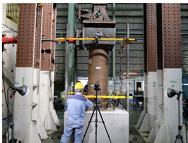
図 2.2.2-2 荷重実験状況
