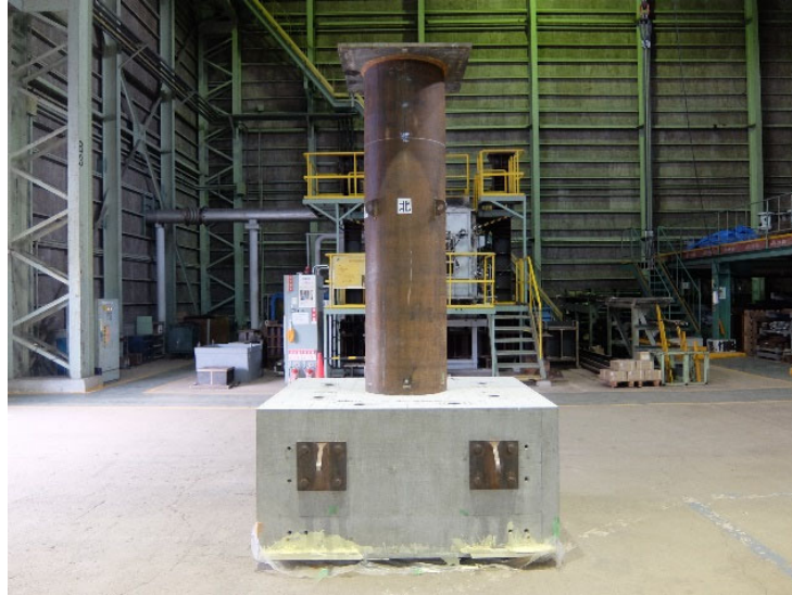
図 2.2.1-2 杭頭載荷実験試験体 (2020 年実施)
