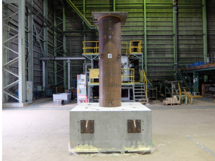
図 2.2.1-2 杭頭載荷実験試験体 (2020 年実施)
