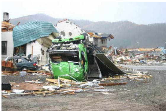
第 3.3 図 竜巻による被災後の 4t トラックの様子 1),2)
