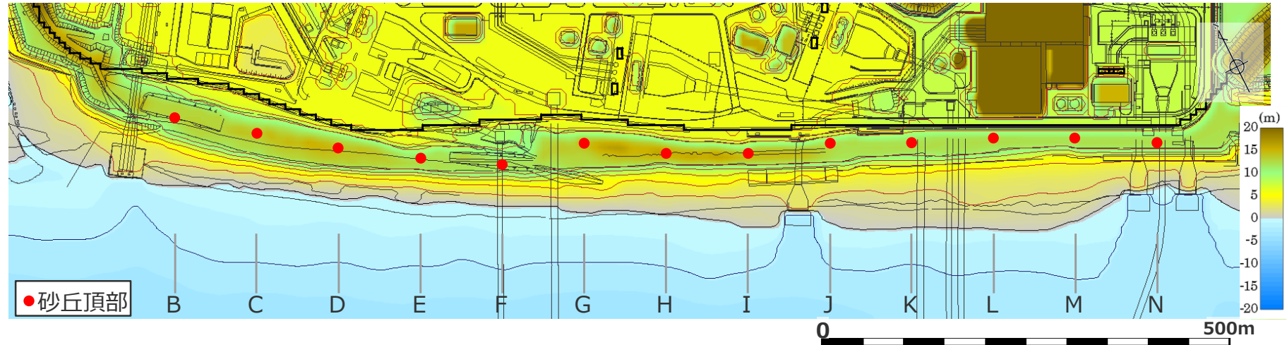
砂丘堤防における津波の最大浸水深、浸水継続時間および最大洗掘量
