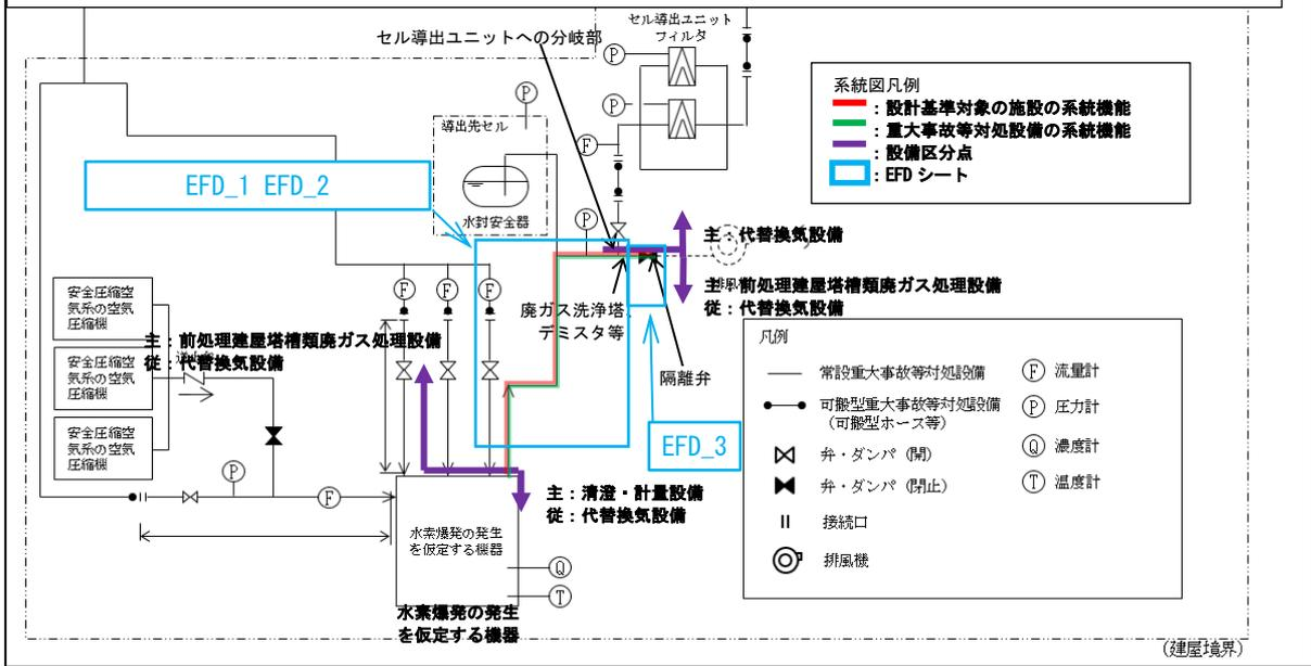
第3-5図 代替換気設備 系統概要図
