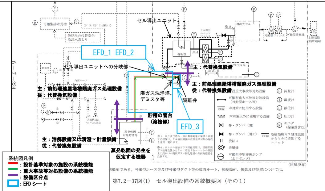
第3-4図 代替換気設備 系統概要図
