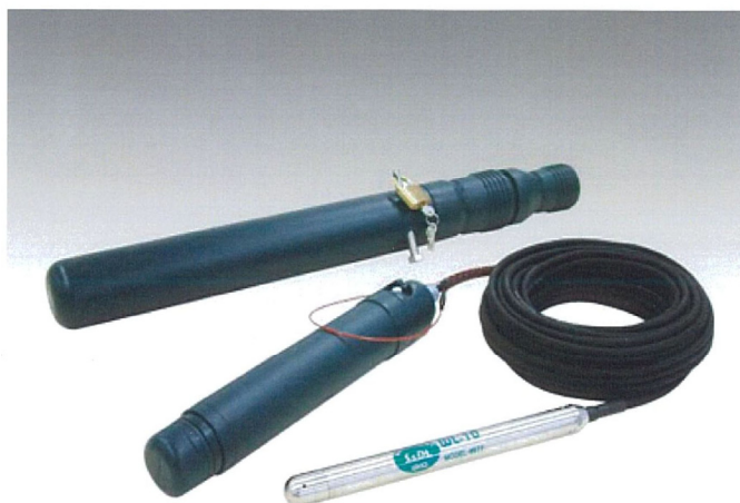
第2-3 図 地下水位観測装置
