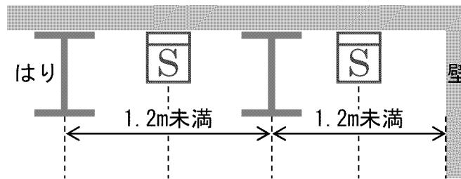
○狭隘箇所においては壁からの離隔距離が0.6m未満の位置であっても、早期に煙が滞留することが想定されるため、左右両側の壁又ははりから可能な範囲で離隔を確保した位置に感知器を設置することで、支障なく火災を感知できるものと考える。そのため、当社原子力発電所において上記の設計事項を適用する。
