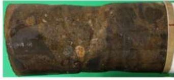
試験後の供試体
