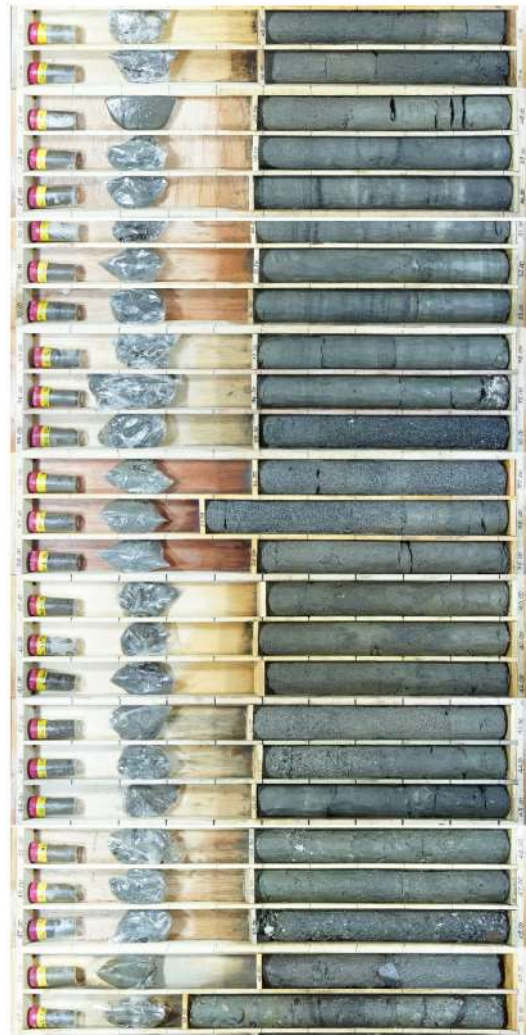
参考 1-38 図(2/3) ボーリング柱状図・コア写真 (SW2-4)
