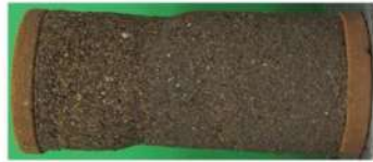
試験後の供試体
