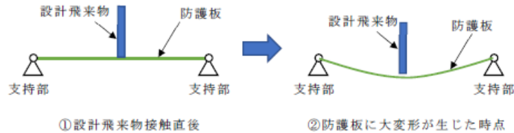
第2-23図 防護板への設計飛来物衝突の進展
