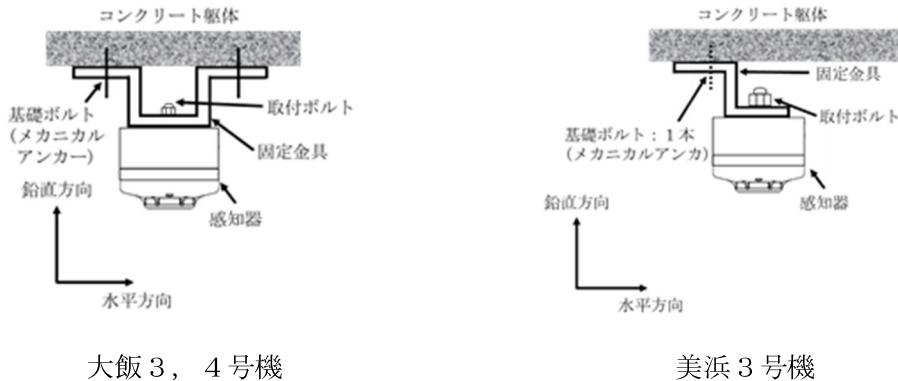
第 5-5-7 図 火災感知器の構造図
