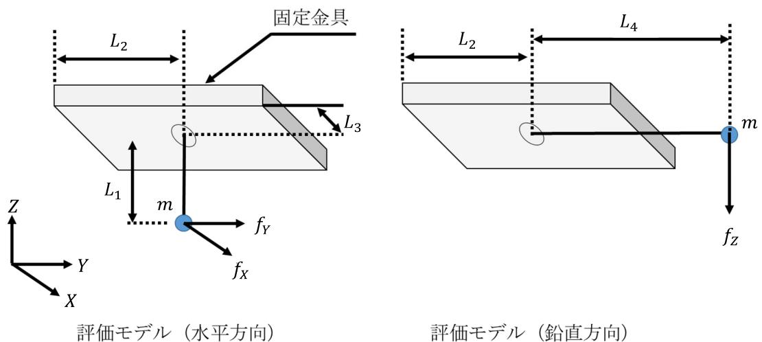
第5・5・3図 一点固定型（天井支持型）の応力評価モデル
