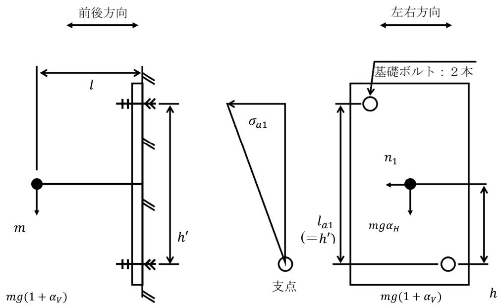
第5-5-5図 二点固定型（壁掛け型）の応力評価モデル（前後方向）
