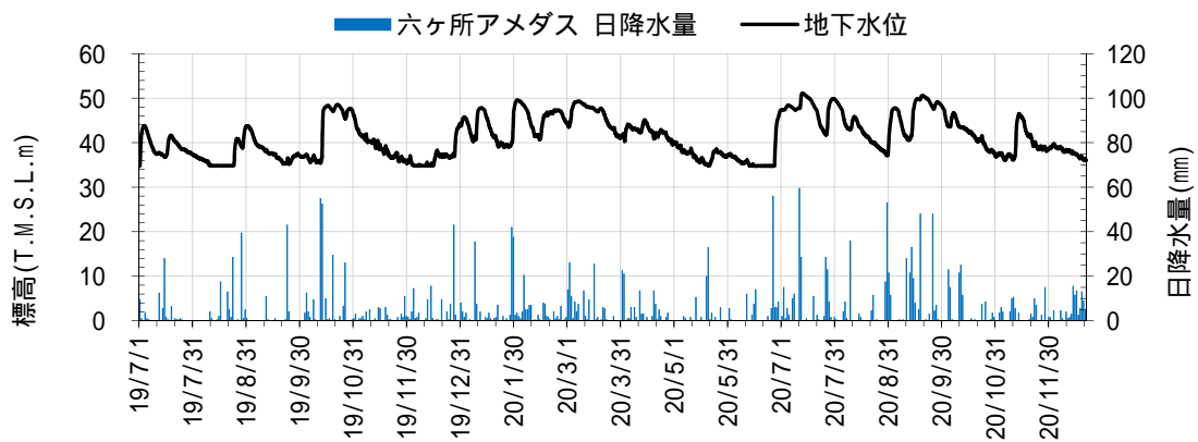
第 1.-1 図(15) ARW-2 孔における地下水位観測記録と降水量データ
