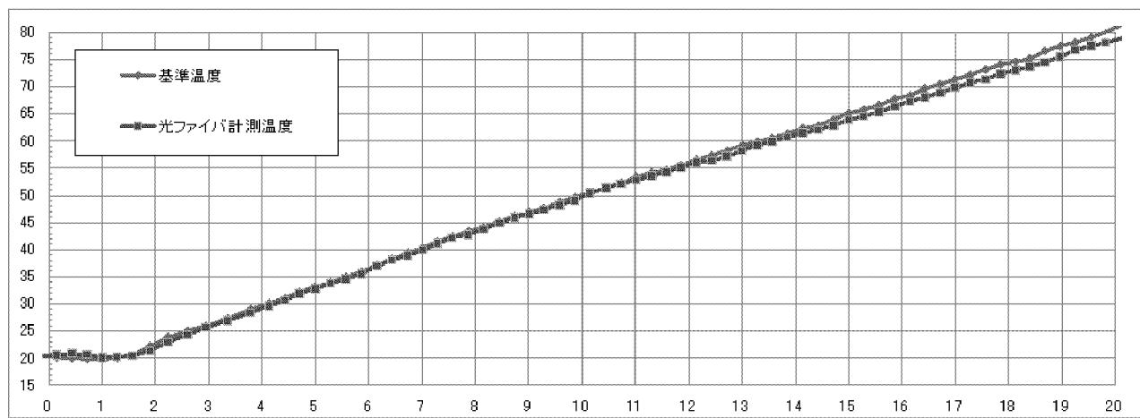
図2 差動分布型熱感知器の感度試験
