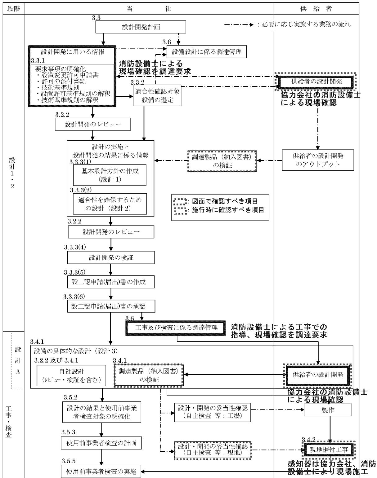
\*1: バックフィットにおける「設計」は、要求事項を満足した設備とするための基本設計方針を作成(設計 1)し、その結果を要求事項として、既に設置されている適合性確認対象設備の現状を念頭に置きながら各要求事項に適合させるための詳細設計(設計 2)を行う行為をいう。
