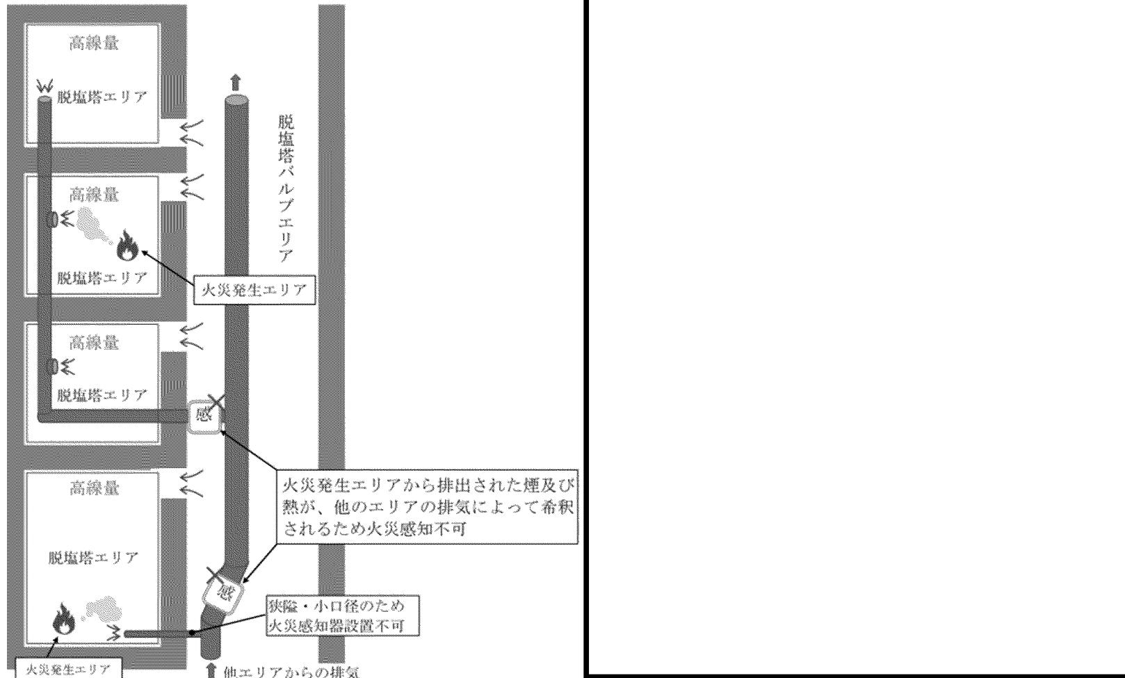
第 7-3-56 図 脱塩塔エリアの換気空調設備排気ダクトの配置概要
