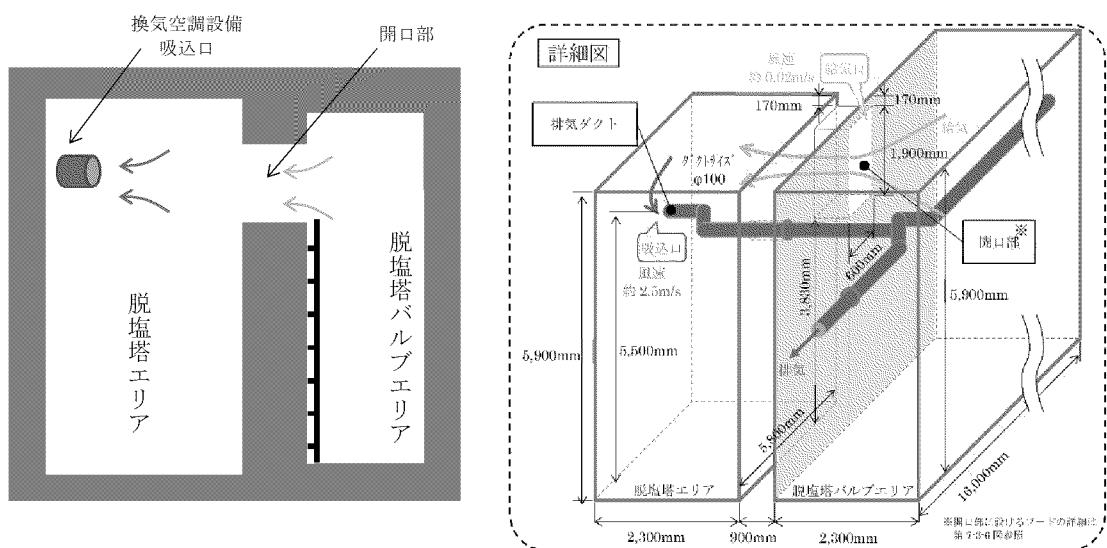
第 7-3-53 図 脱塩塔エリアの空気の流れの概要
