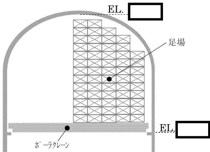
第7-3-34図 原子炉格納容器頂部への感知器設置に要する足場概要図
