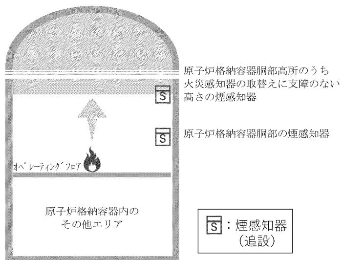
第7-3-31図 中規模な火災における煙の流動
