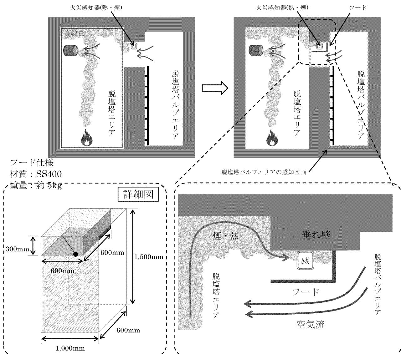
第 7-3-55 図 脱塩塔エリア開口部におけるフードを用いた
