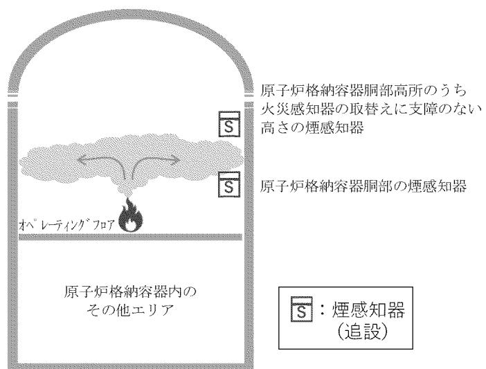
第7-3-32図 小規模な火災における煙の流动
