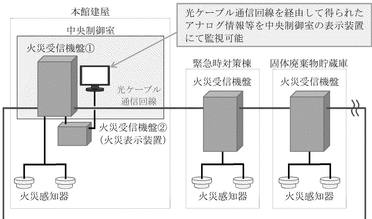
第 8-1-1 図 火災受信機盤の概略系統図
