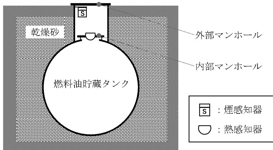
第 7-4-41 図 燃料油貯蔵タンクエリアに対する火災感知器の設置方法
