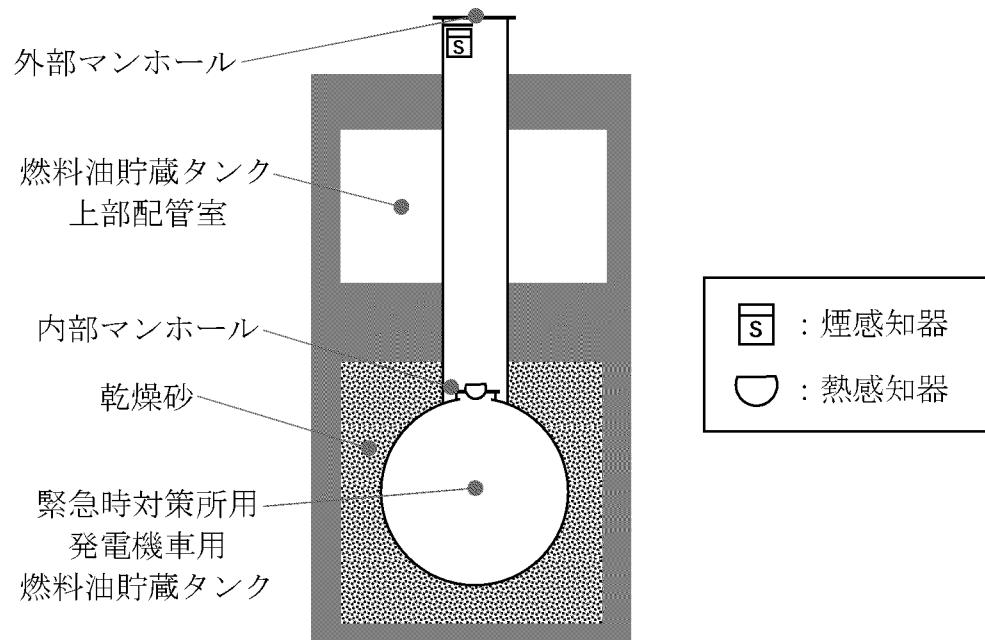
第 7-4-42 図 緊急時対策所用発電機車用燃料油貯蔵タンク室に対する
