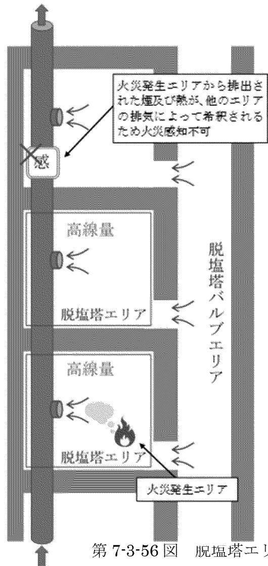
第 7-3-56 図 脱塩塔エリアの換気空調設備排気ダクトの配置概要
