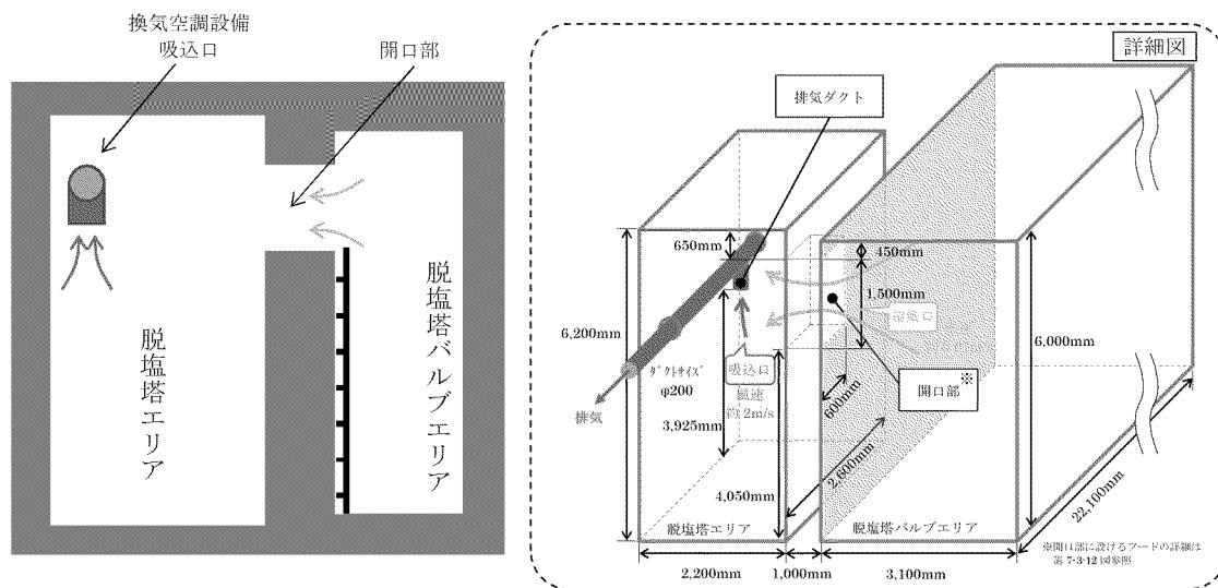
第 7-3-53 図 脱塩塔エリアの空気の流れの概要
