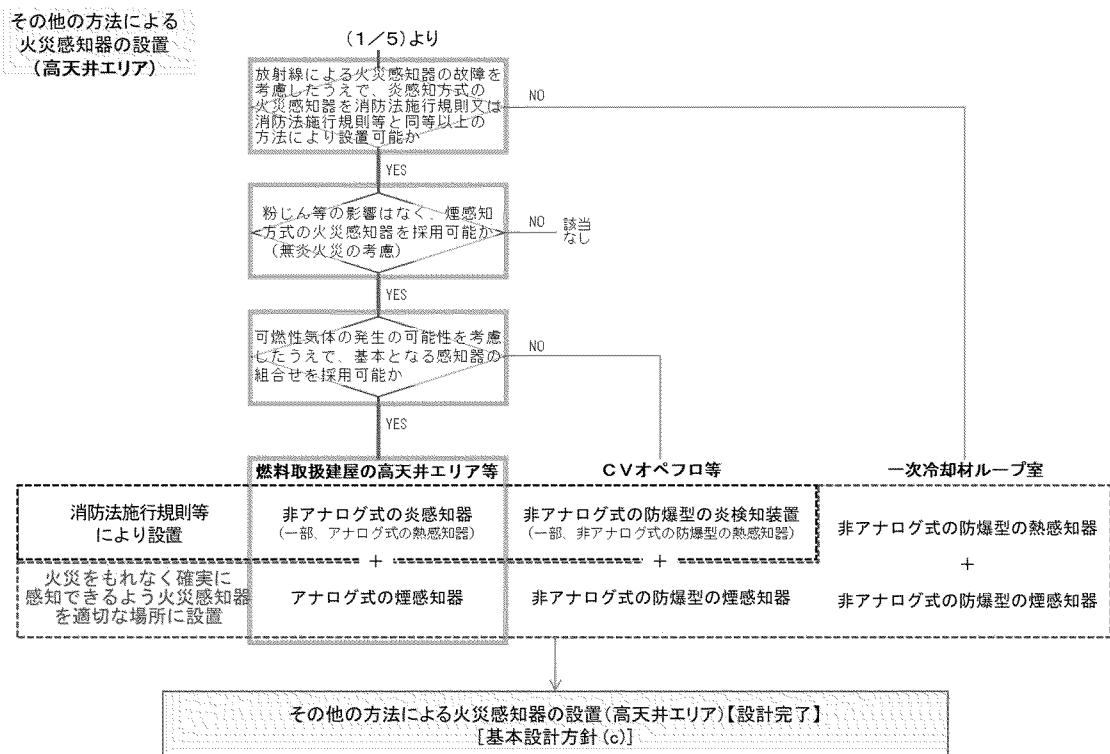
第 7-3-16 図 使用済燃料ピット水タンク室の火災の感知の
