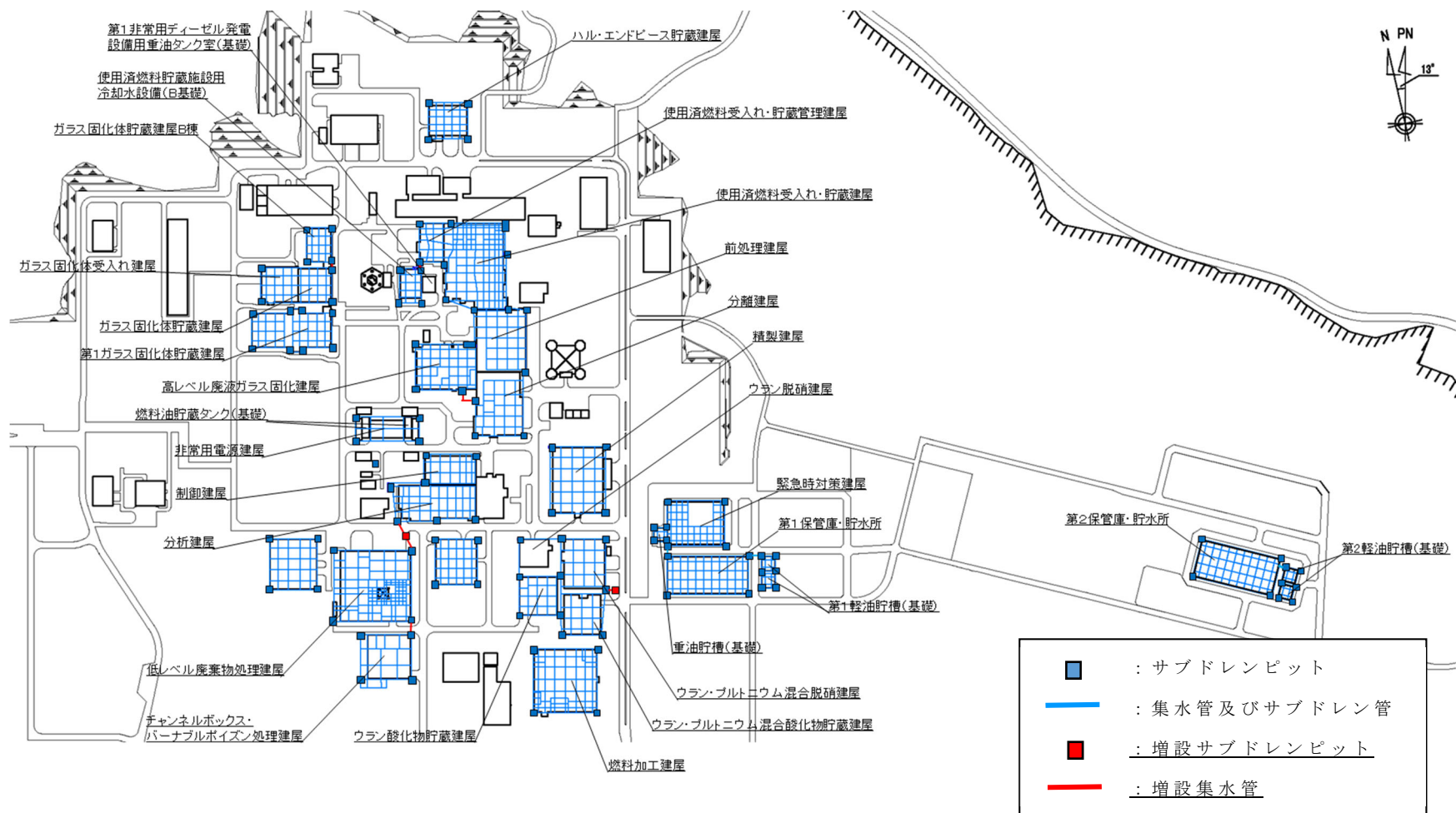
第 4.2-2 図 集水管及びサブドレン管の敷設
