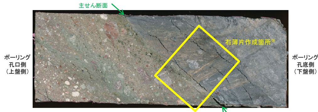
半割コア写真(OS-8孔) ※隣接孔(OS-5孔)の条線方向が概ね高角(110° R)であることから、90° Rの方向で薄片を作成した。
