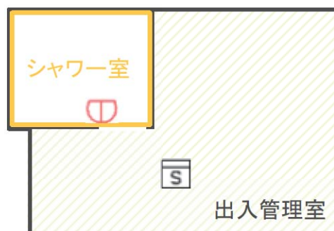
図7-5-2-8 ホットシャワー室監視用の煙感知器配置
