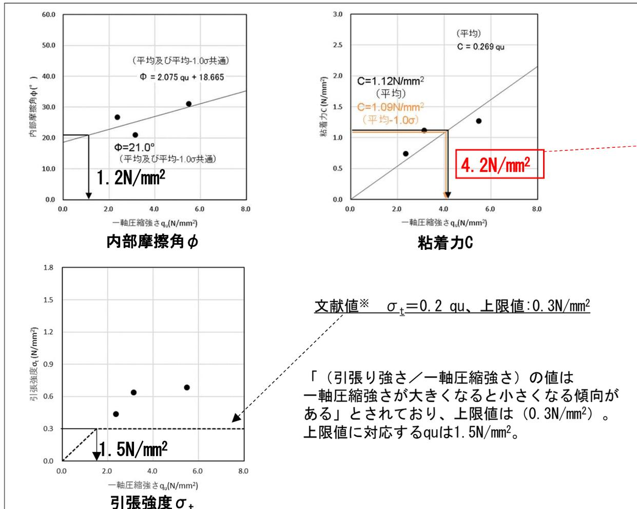
図1 室内配合試験による一軸圧縮強度 $q_u$ と評価に用いる強度特性の相関関係(Mu-S<sub>2</sub>層)
