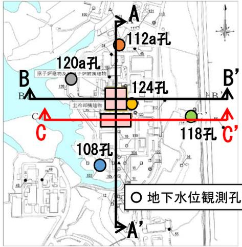
・東西方向の地下水位について、大洗研内の広域的な水位は、敷地西側にあるHTTR及びJMTRでT.P.+約10 m、敷地東側にある「常陽」近傍(124孔)でT.P.+約6 m、「常陽」東側(118孔)でT.P.+3.9 mである。
