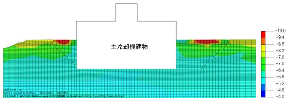
最大加速度(水平成分)(m/s<sup>2</sup>)
