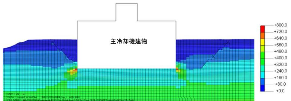
最大せん断応力(kN/m<sup>2</sup>)
