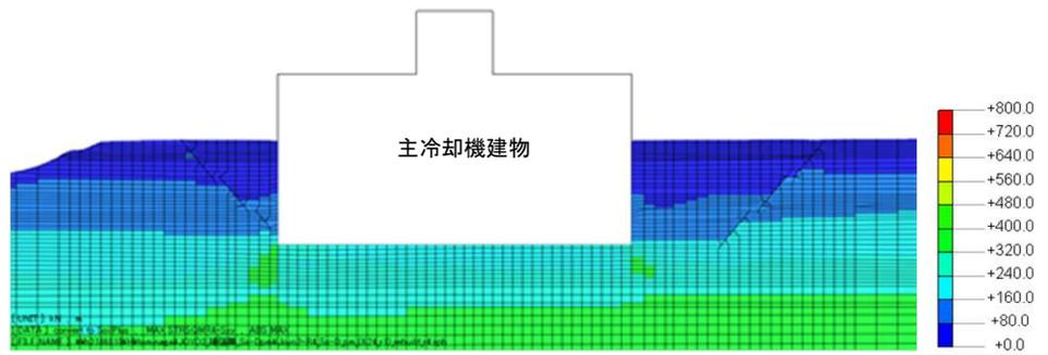
最大せん断応力(kN/m<sup>2</sup>)
