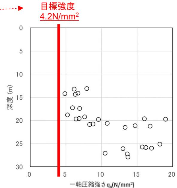
図2 試験施工の改良体のコアを用いた一軸圧縮試験結果
