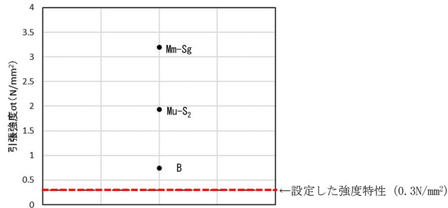
現地改良体 B (埋戻土)、Mu-S<sub>2</sub> (砂層)、Mm-Sg (砂礫層)
