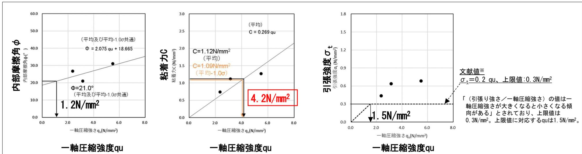
室内配合試験による一軸圧縮強度 $q_u$ と評価に用いる強度特性の相関関係
