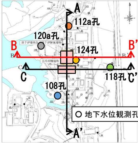
・東西方向の地下水位分布について、原子炉建物近傍にある124孔でT.P.+6.0 m、西側(陸側)にある120a孔でT.P.+7.0 m、東側(海側)にある118孔でT.P.+3.9 mである。
