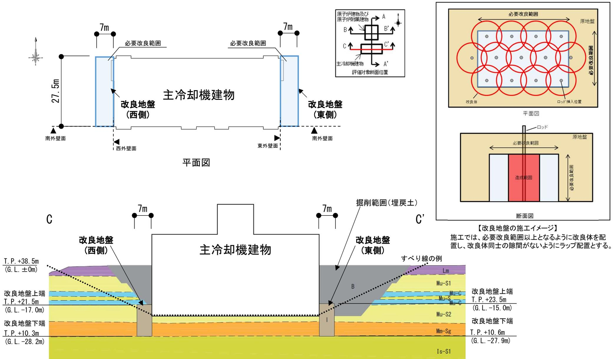
図 断面図 (東西 (C-C') 断面)
