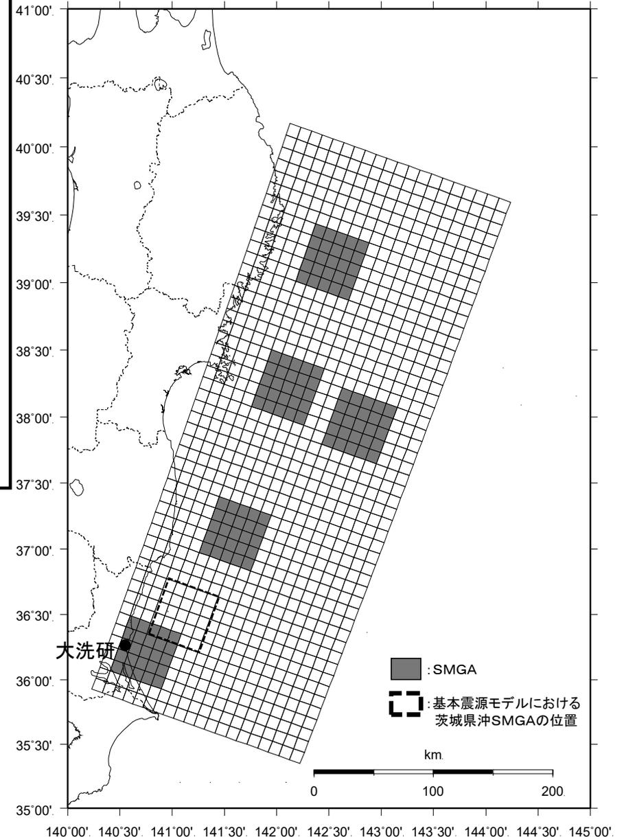
2011年東北地方太平洋沖型地震の震源断層モデル
