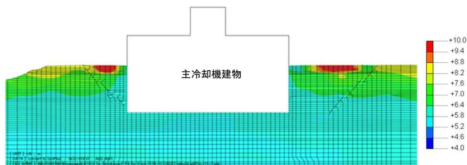
最大加速度(水平成分)(m/s<sup>2</sup>)
