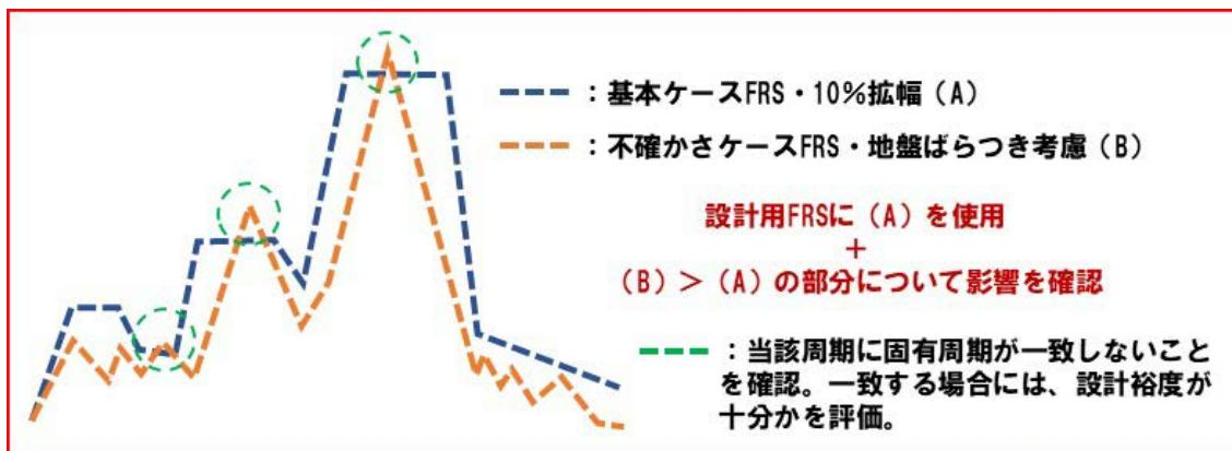
上記の設計用 FRS に相当するものの作成は完了している。今後、早期に提示する。また、当該設計用 FRS を用いた機器・配管系等の代表的な耐震評価結果についても順次提示する。
