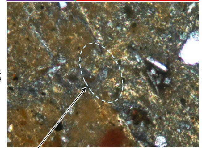
不連続箇所の粘土鉱物(I/S混合層)に変位・変形(せん断面や引きずりなど)は認められない
