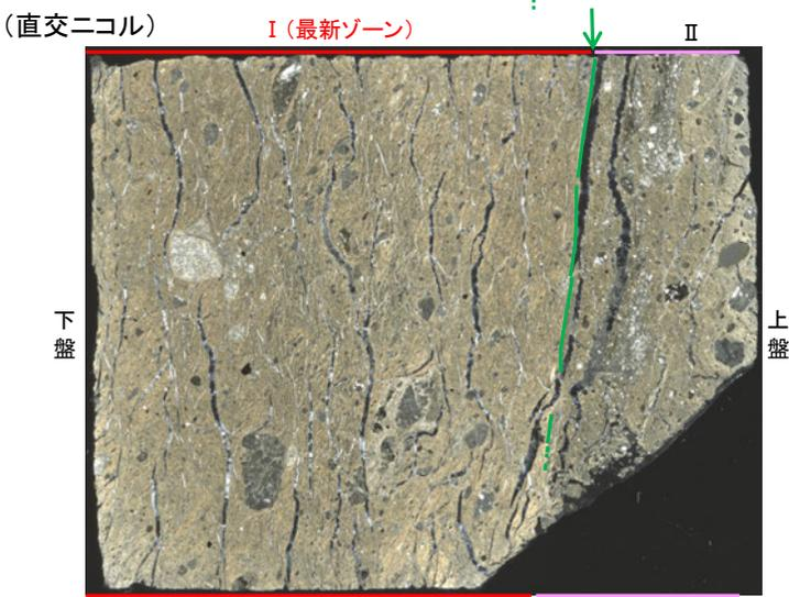
I : 単ニコルで褐灰色, 直交ニコルで黄～灰色の干渉色を呈する, 粘土鉱物を含む細粒物からなる。径6mm以下の岩片や鉱物片が細粒な基質中に含まれる。岩片, 鉱物片は角～亜円形である。基質中には粘土鉱物が生成している。
