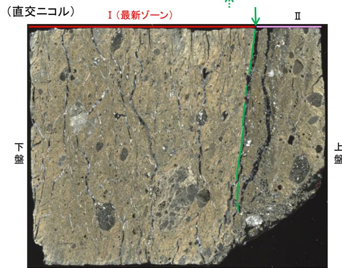
I (最新ゾーン): 単ニコルで褐灰色, 直交ニコルで黄~灰色の干渉色を呈する, 粘土鉱物を含む細粒物からなる。径5mm以下の岩片や鉱物片が細粒な基質中に含まれており, 径12mm程度の岩片も認められる。岩片, 鉱物片は垂角~垂円形である。基質中には粘土鉱物が生成している。
