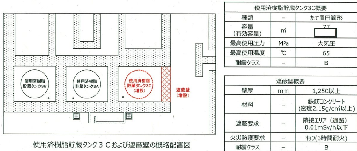
図2 使用済樹脂貯蔵タンク 3 Cの概略配置および仕様
