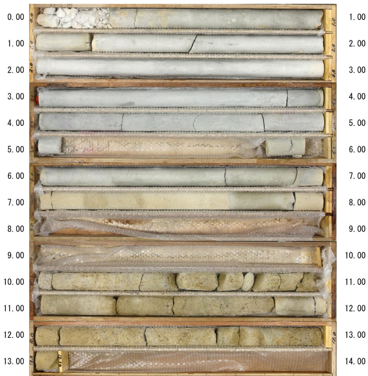
図 2-8 中詰材改良体（砂）のコア写真
