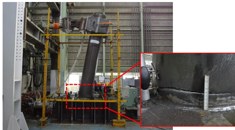
図 2.2-14 水平載荷実験終了時の状況（実験ケース②）
