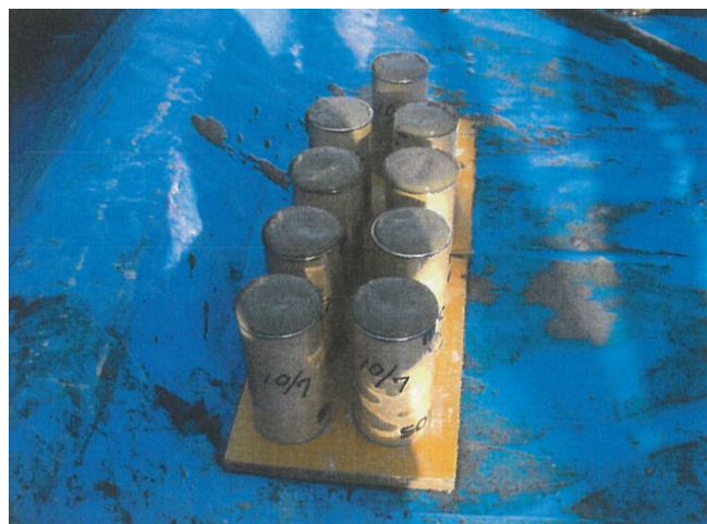
図 4-6 グラウトの一軸圧縮強度試験テストピース
