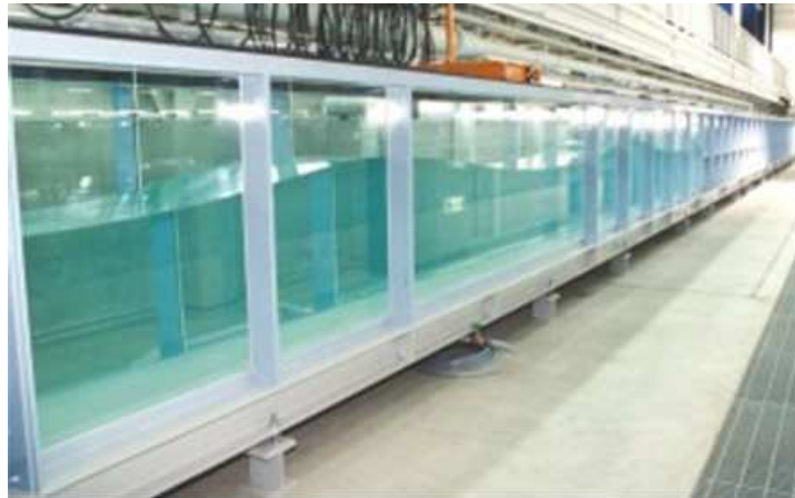
図 1.6.2-12 水理模型実験装置
