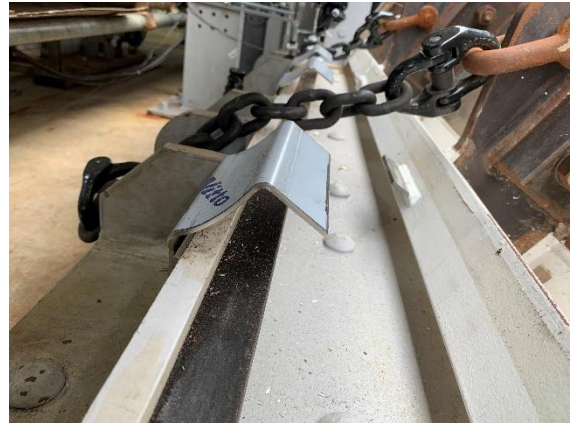
図 2-1 クリップの固定状態及び脱落状態
