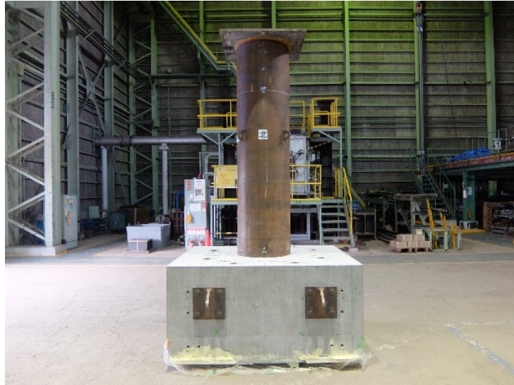
図 2.3.2-3 杭頭載荷実験試験体 (2020 年実施)
