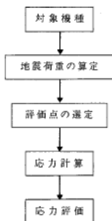
図 6.6.1-1 応力・強度解析の基本的な流れ
