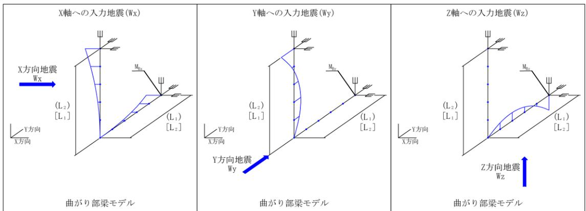
第4.5.5.1-6図(2/2) 配管(曲がり部)モデル<鉛直配管>
