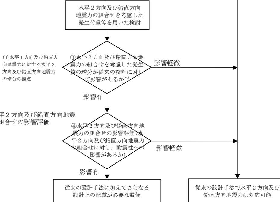
第4-1図(3/3) 水平2方向影響検討フロー(機器・配管系)
