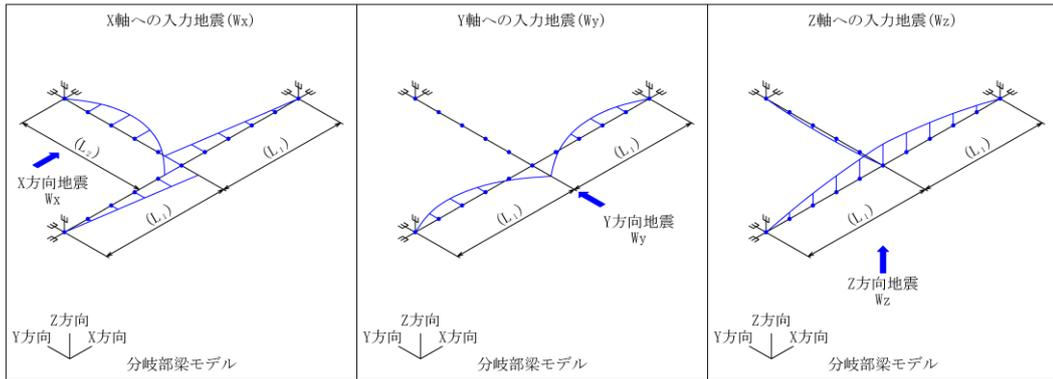
第4.5.5.1-8図(1/3) 配管(分岐部)モデル<水平配管>
