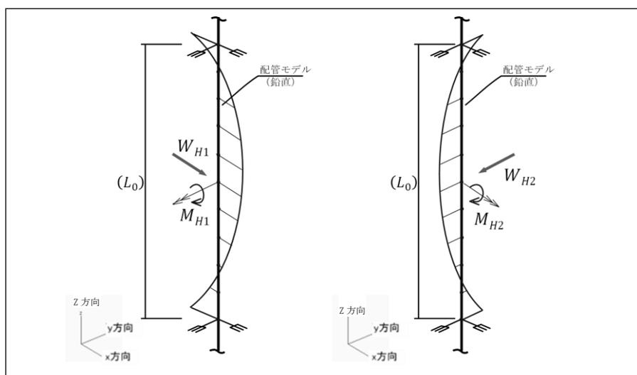
第4.5.5.1-3図 水平地震による鉛直配管の発生曲げ荷重概念図
