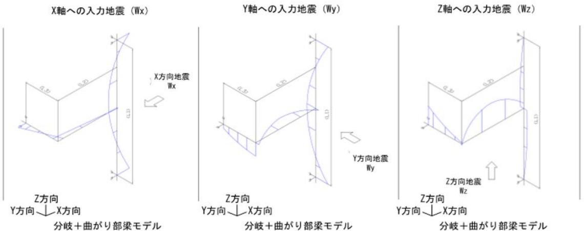
第4.5.5.1-16図(2/2) 配管(分岐+曲がり部)モデル<鉛直配管>
