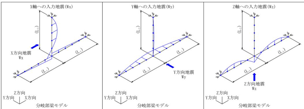
第4.5.5.1-8図(2/3) 配管(分岐部)モデル<鉛直配管(1)>
