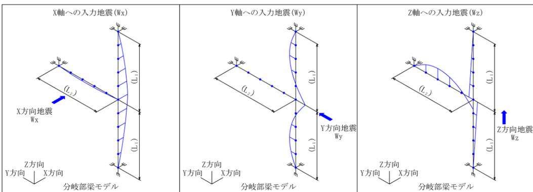
第4.5.5.1-8図(3/3) 配管(分岐部)モデル<鉛直配管(2)>
