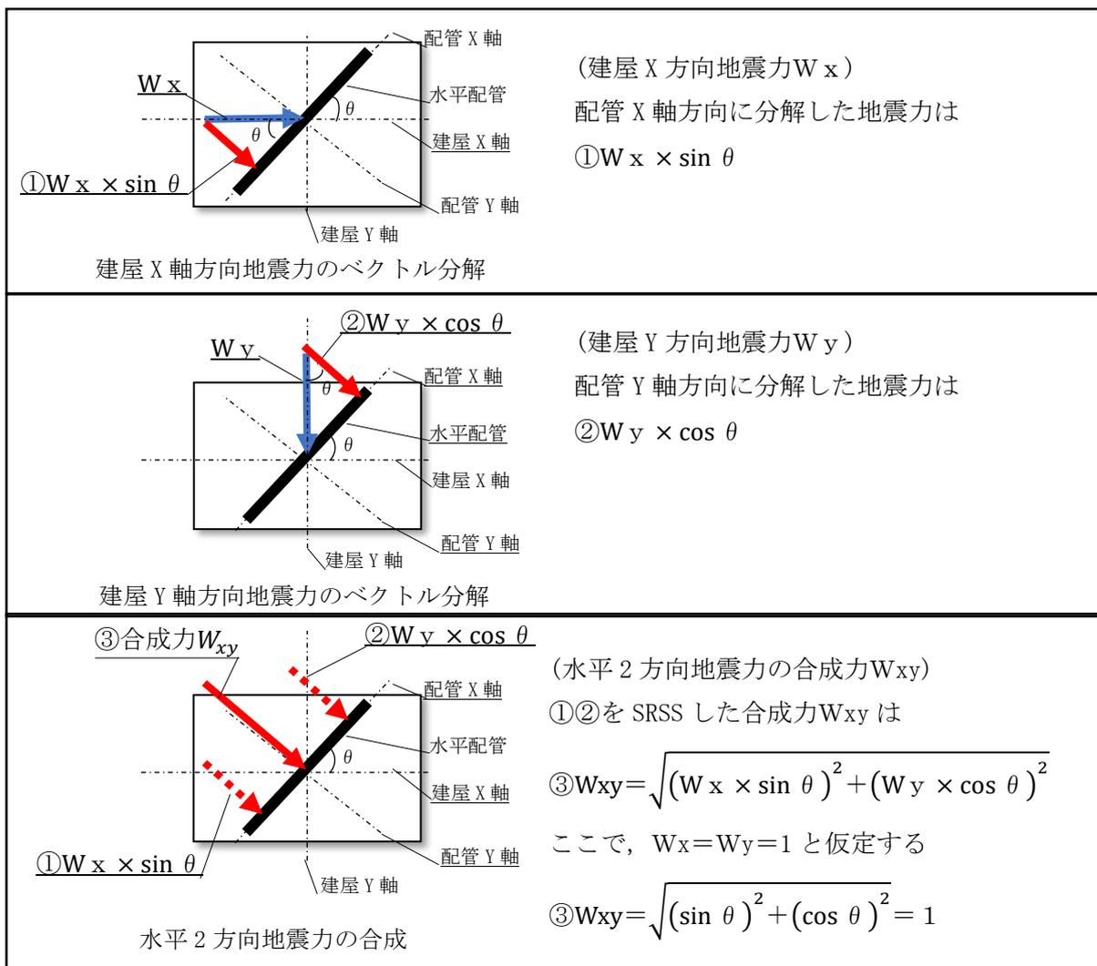
第4.5.5.1-2図 建屋応答軸と角度を有した配管配置
