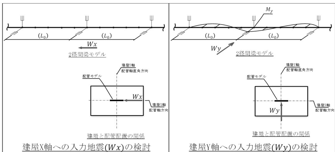
第4.5.5.1-1図 建屋X軸に沿った配管配置
