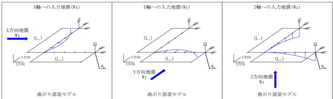
第4.5.5.1-6図(1/2) 配管(曲がり部)モデル<水平配管>
