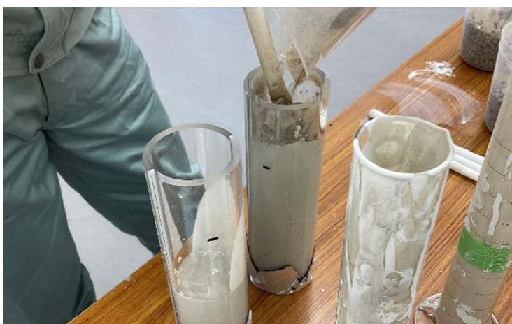
図 4.5.1-5 供試体の作製状況
