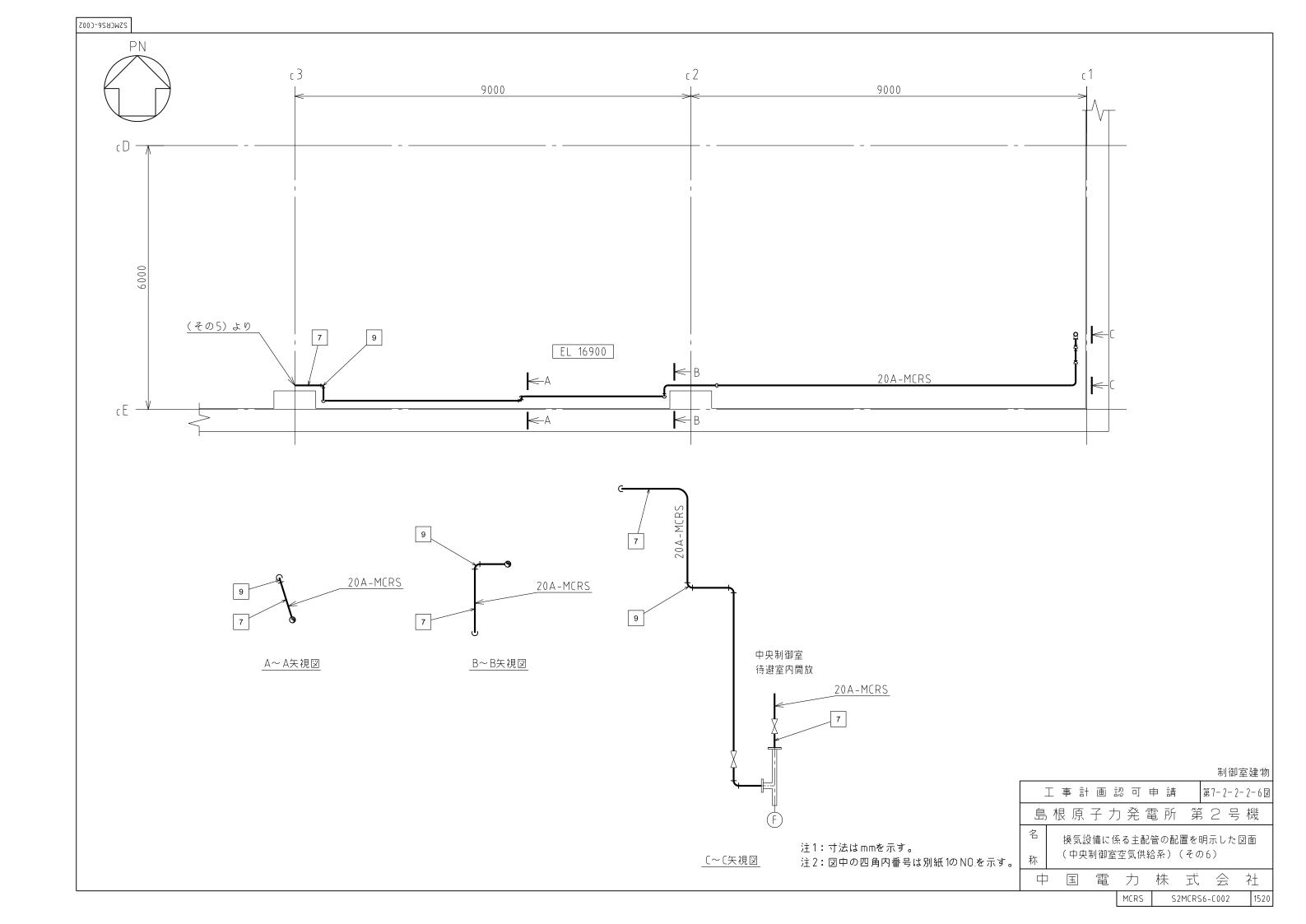
第 7-2-2-2-1~6 図 換気設備に係る主配管の配置を明示した図面(中央制御室空気供給系) 別紙 1 工事計画抜粋
