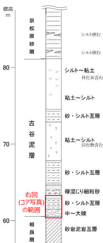
ボーリング調査(W30孔)により作成した比木2地点の模式柱状図
