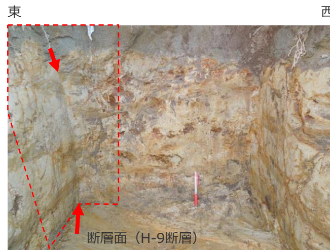
② 観察位置 (赤枠は前頁のスケッチ範囲) (左写真南面追加掘削)
