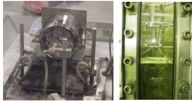
機器洗浄作業 (洗浄治具/装荷状態 (覗き窓))
