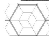
集合体 (燃料集合体、反射体、遮へい集合体) 及びラツバ管間ギャップ部のメッシュ配置図
