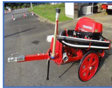
[可搬型消防ポンプ]
