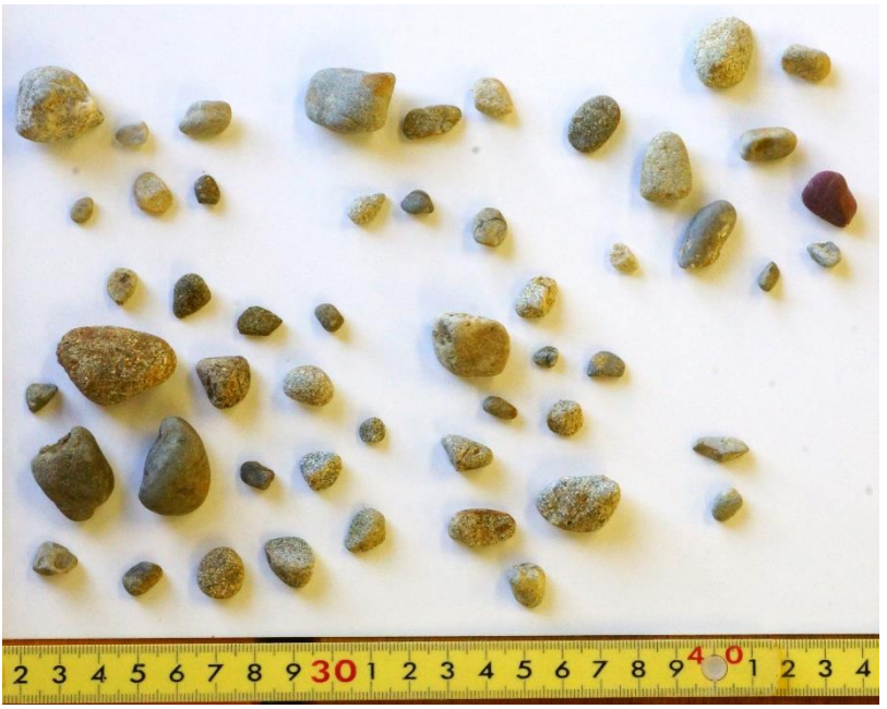
①砂岩・頁岩・チャートの円～扁平礫の写真（BF1-1孔ボーリングコアの該当区間を半割して採取）
