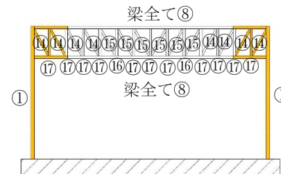
第 4-1 図 飛来物防護ネット (3/4) C-C, J-J 及び K-K 断面
