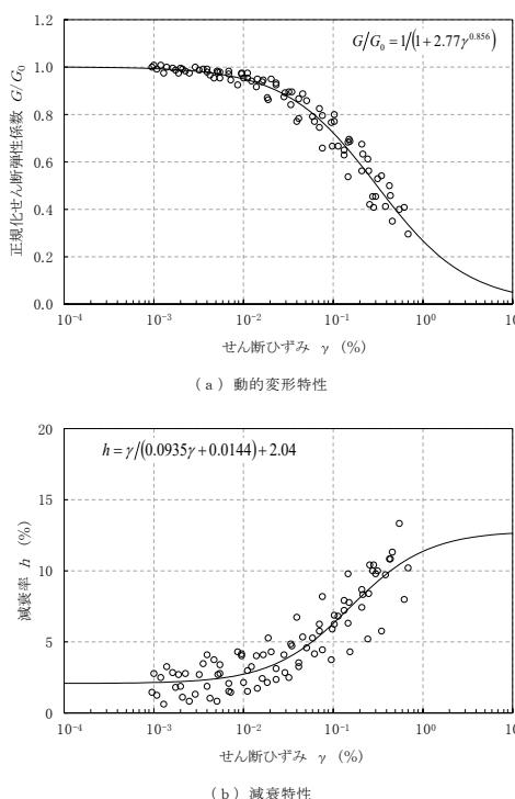
第3-1図 (10) 変形特性のひずみ依存性 (砂岩・凝灰岩互層[Talst])
