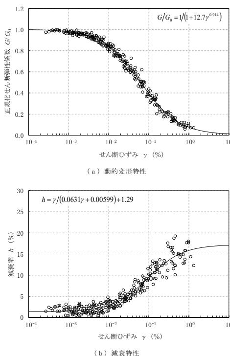
第3-1図 (22) 変形特性のひずみ依存性 (埋戻し土[bk])
