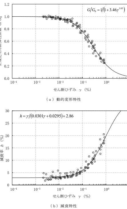
第3-1図 (16) 変形特性のひずみ依存性 (f-2断層)
