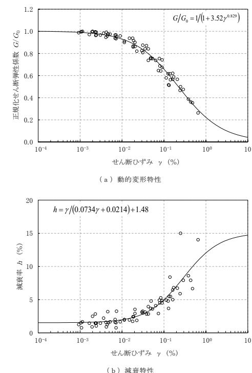
第3-1図 (12) 変形特性のひずみ依存性 (軽石混り砂岩[Tps])
