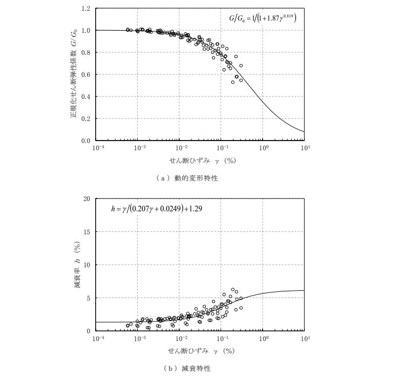
第3-1図(6) 変形特性のひずみ依存性(細粒砂岩[Tfs])
