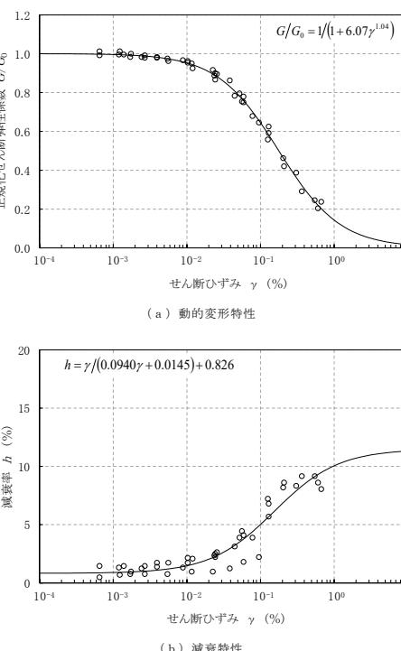
第3-1図(8) 変形特性のひずみ依存性(軽石質砂岩[Tpps])
