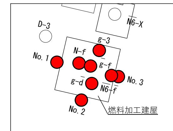
● : 地盤モデルの作成に用いるPS検層孔
