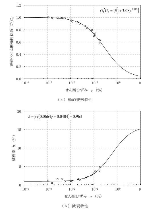
第3-1図 (14) 変形特性のひずみ依存性 (砂岩・泥岩互層[Talsm])
