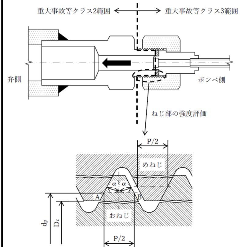
図2-4 ねじ込み継手概要図
