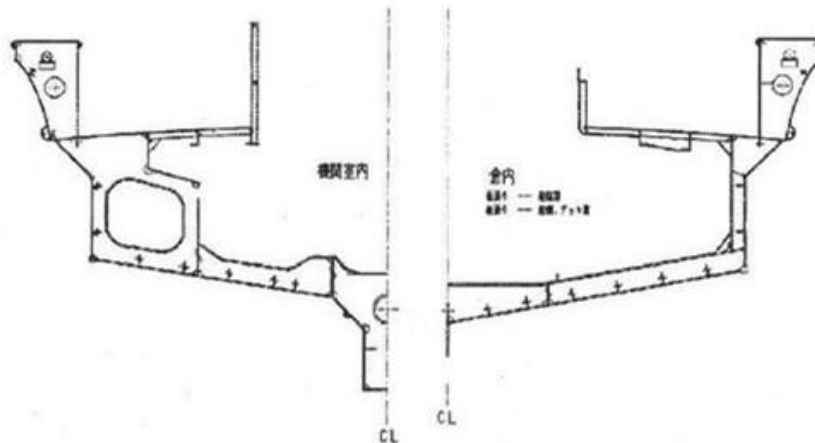
図-2.2 アルミ合金漁船の中央断面図
