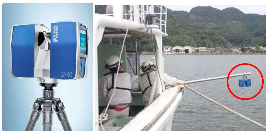
図 4.5.6-3 3Dレーザースキャナによる計測状況
