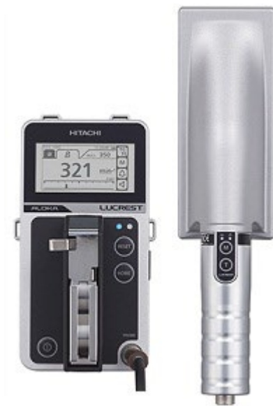
第6図 アルファ・ベータ線用サーベイメータ （汚染）
