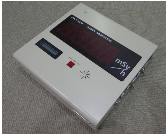
第5図 緊急時対策所エリアモニタ
