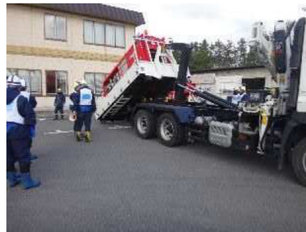
中型移送ポンプの運搬
