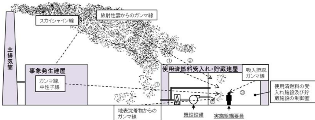
(a) 臨界事故の発生時の被ばく経路
