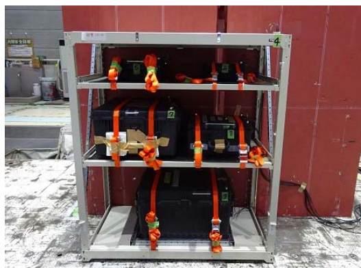
収納箱を模擬保管棚に固縛した状態
