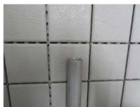
配管: SUS304 25A SCH20S (外径34.0mm 厚さ3.0mm) 小口径配管切断
