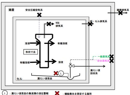
:漏えい液受皿の集液溝の液位警報
