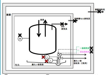
(L) :漏えい液受皿の集液溝の液位警報 基準地震動を1.2倍にした地震動を 考慮する設計 (DA) : 第2よう素追出し槽の溶液密度高による警報 💥 : 機能喪失を想定する箇所
