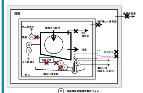
:漏えい液受皿の集液溝の液位警報
