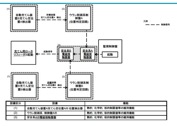
Ⅲ-35 脱硝装置の温度計による脱硝皿取扱装置の起動回路及び照度計による シャッタの起動回路の系統図
