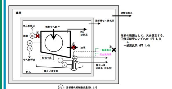
:漏えい液受皿の集液溝の液位警報
