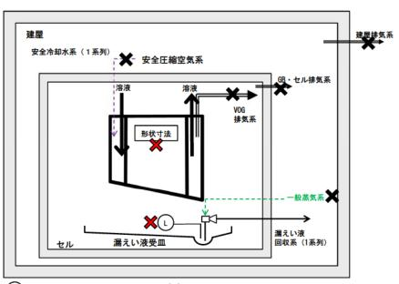
(L):漏えい液受皿の集液溝の液位警報 :基準地震動を1.2倍にした地震動を 考慮する設計 :機能喪失を想定する箇所
