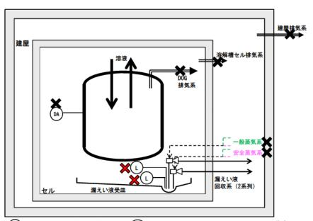
(L) :漏えい液受皿の集液溝の液位警報 基準地震動を1.2倍にした地震動を 考慮する設計 (DA) : 第1よう素追出し槽の溶液密度高による警報 💥 : 機能喪失を想定する箇所
