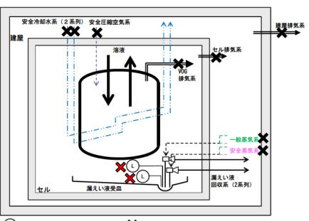
:漏えい液受皿の集液溝の液位警報
