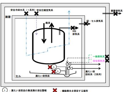
(L) :漏えい液受皿の集液溝の液位警報
