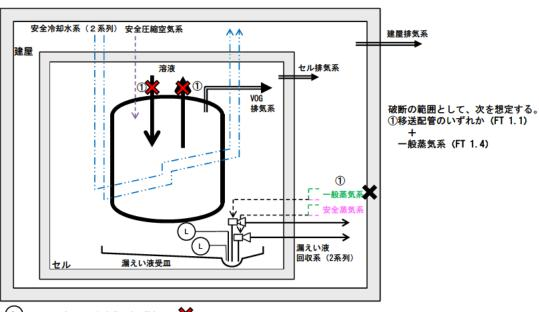
(L) :漏えい液受皿の集液溝の液位警報 × :機能喪失を想定する箇所
