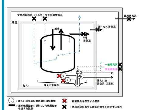
I-24 第3一時貯留処理槽の系統図(機能喪失状態の特定) ※3 配管の全周破断
