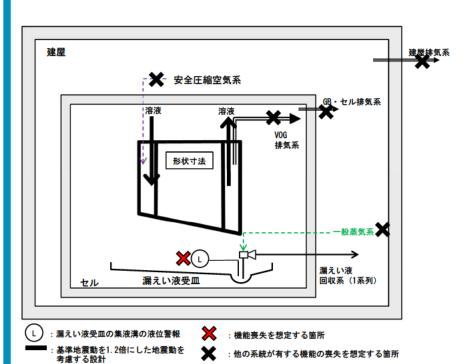
I-20 プルトニウム溶液受槽の系統図(機能喪失状態の特定) ※3 配管の全周破断
