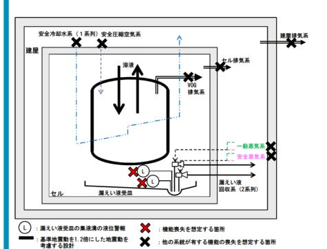
I-10 計量補助槽の系統図(機能喪失状態の特定) ※3 配管の全周破断
