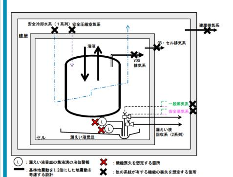
抽出塔の系統図(機能喪失状態の特定) -14**※** 1 地震
