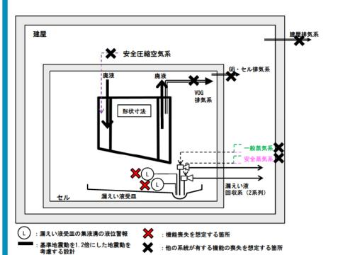
I - 24第3一時貯留処理槽の系統図(機能喪失状態の特定) Ж 1 地震
