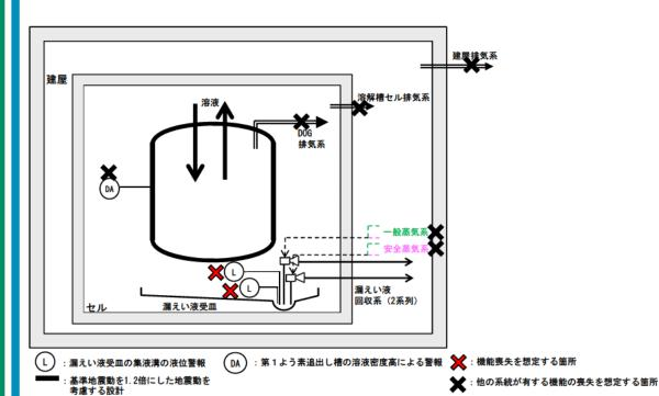
第1よう素追出し槽の系統図(機能喪失状態の特定) ※3 配管の全周破断
