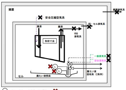
(L) :漏えい液受皿の集液溝の液位警報 基準地震動を1.2倍にした地震動を 考慮する設計
