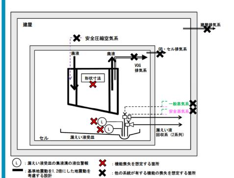
I - 23第2一時貯留処理槽の系統図(機能喪失状態の特定) **※2** 火山の影響
