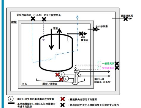
I - 8 計量前中間貯槽の系統図(機能喪失状態の特定) ※3 配管の全周破断
