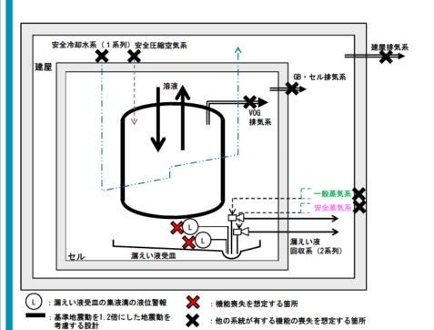
I-13 溶解液供給槽の系統図(機能喪失状態の特定) ※2 火山の影響
