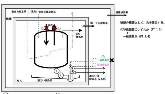
(L) :漏えい液受皿の集液溝の液位警報 : 基準地震動を1.2倍にした地震動を 考慮する設計 : 機能喪失を想定する箇所
