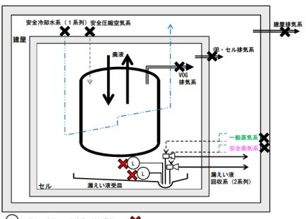
(L) :漏えい液受皿の集液溝の液位警報
