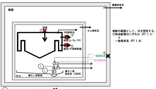
(L) :漏えい液受皿の集液溝の液位警報
