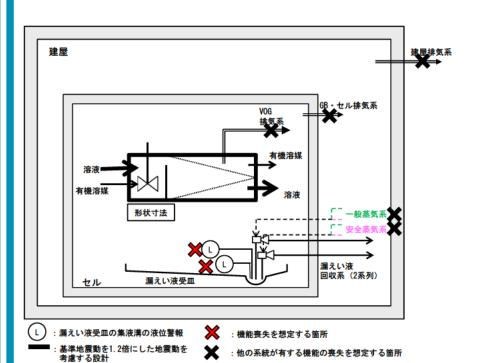
I-20 プルトニウム溶液受槽の系統図 (機能喪失状態の特定) ※1 地震
