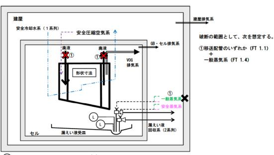
(L):漏えい液受皿の集液溝の液位警報 :基準地震動を1.2倍にした地震動を 考慮する設計
