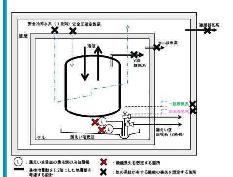
I-12 溶解液中間貯槽の系統図(機能喪失状態の特定) ※1 地震
