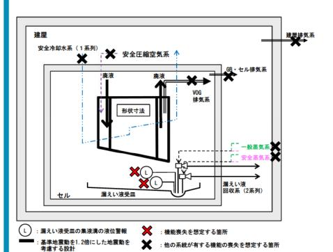
I-22 第1一時貯留処理槽の系統図(機能喪失状態の特定) ※3 配管の全周破断
