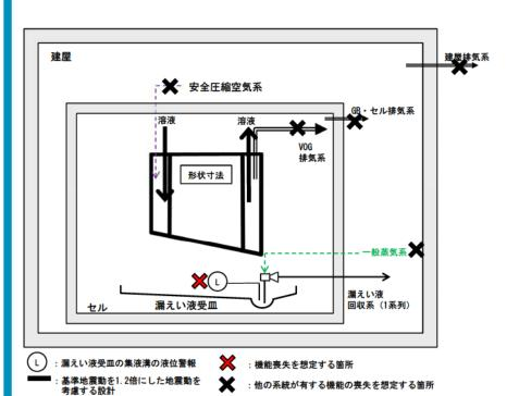
I - 22第1一時貯留処理槽の系統図(機能喪失状態の特定) **※** 1 地震
