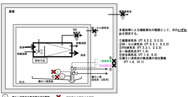
L :漏えい液受皿の集液溝の液位警報
