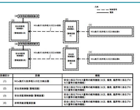
**Ⅲ** − 4 3 ウラン・プルトニウム混合脱硝建屋塔槽類廃ガス処理設備の系統の圧力 警報の系統図
