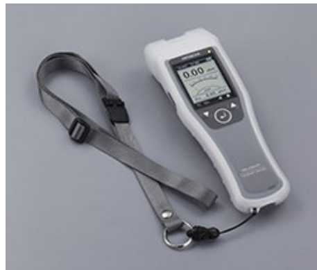
第 7 図 サーベイメータ（線量率）
