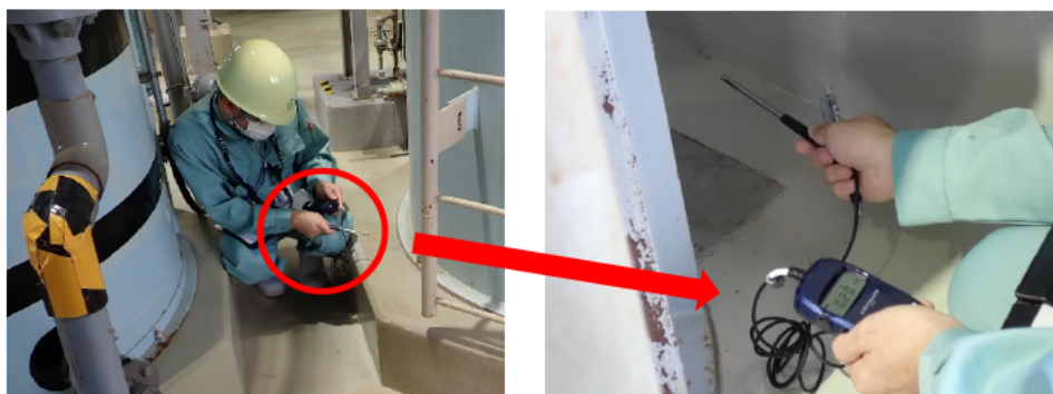
第2図 敷地内の固定源周りの風速及び温度の測定状況 (第2 一般排水処理建屋)
