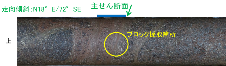
固結した破碎部 ボーリングコア写真(N-2.3-1孔)
