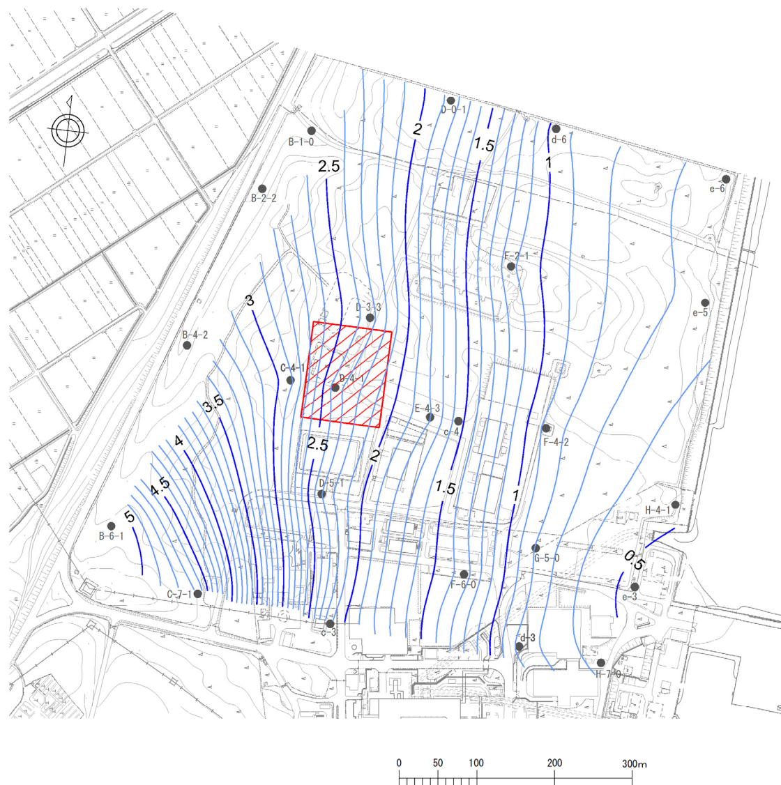
第 8 図 地下水位等高線図 (C-4-1~c-4 ; 動水勾配最大時, 2007/2/14 14 時)
