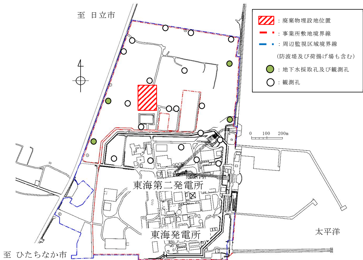
第 12 図 地下水採取孔及び観測孔の設置位置案
