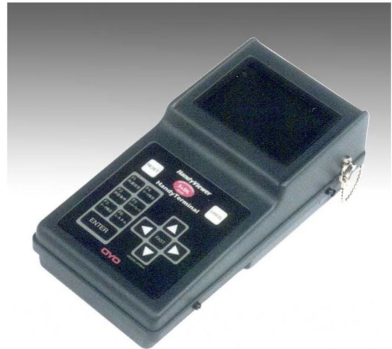
第 1.6.2-3 図 地下水位計測データ採取装置
